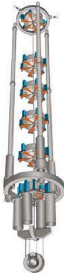
Le vibrazioni sismiche del terreno sono miliardi di volte più grandi delle variazioni di distanza indotte dalle onde gravitazionali. Di conseguenza è essenziale evitare movimenti spuri dei componenti ottici. L'isolamento sismico viene realizzato attraverso una catena di filtri sismici equipaggiati di molle a balestra triangolari. Le molle provvedono all'isolamento nella direzione verticale mentre il pendolo composto assicura l'isolamento nella direzione orizzontale.
